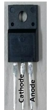
<제작 완료 된 6인치 SiC 웨이퍼 및 패키지>
